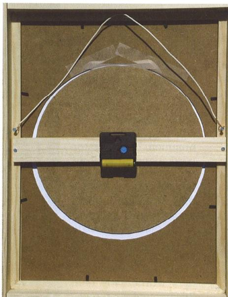
Die drehbare Sternkarte von hinten. Holzleisten an den Rahmenrändern vergrössern den Wandabstand, damit das Uhrwerk Platz hat, welches das runde Sternfeld antreibt und über einen Holzsteg mit dem Bild verbunden ist. Die weisse Schnur erleichtert das Aufhängen. Auf der Oberseite wurde etwas gleitender Kunststoff befestigt, damit die Sternenscheibe einen gleichmässigen Abstand zum Horizontblatt hat. (Foto: Thomas Knoblauch)
